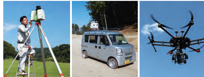
TLS測量 MMS測量 UAV写真測量
